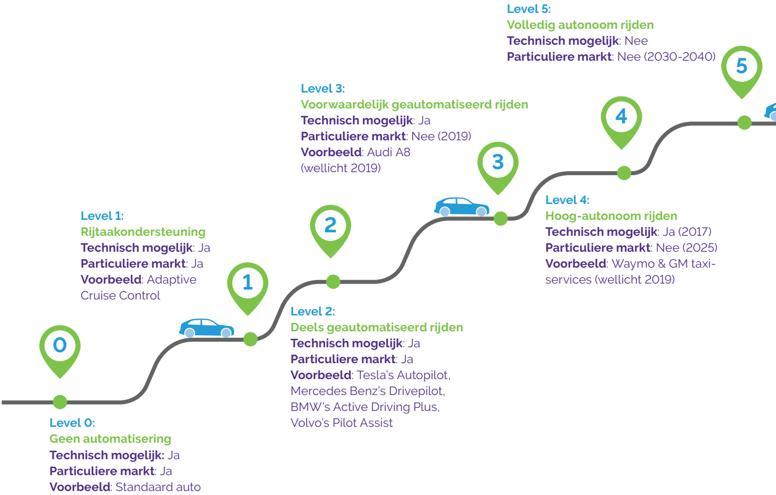
Figuur 3.4 De 5 fases van autonoom rijden
